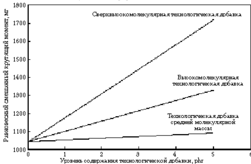
Рис. 6.11. Влияние технологических добавок на равновесный смешанный крутящий момент Haake состава K = 51 при 160\text{ }^{\circ}\text{C}
