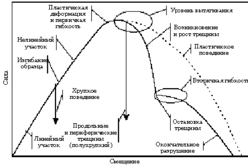
Рис. 6.14. Разделение различных событий во время разрушения, полученное в ходе испытаний ([36], с разрешения авторов)
