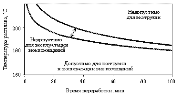
Рис. 14.9. Влияние времени и температуры переработки на устойчивость к атмосферным воздействиям
