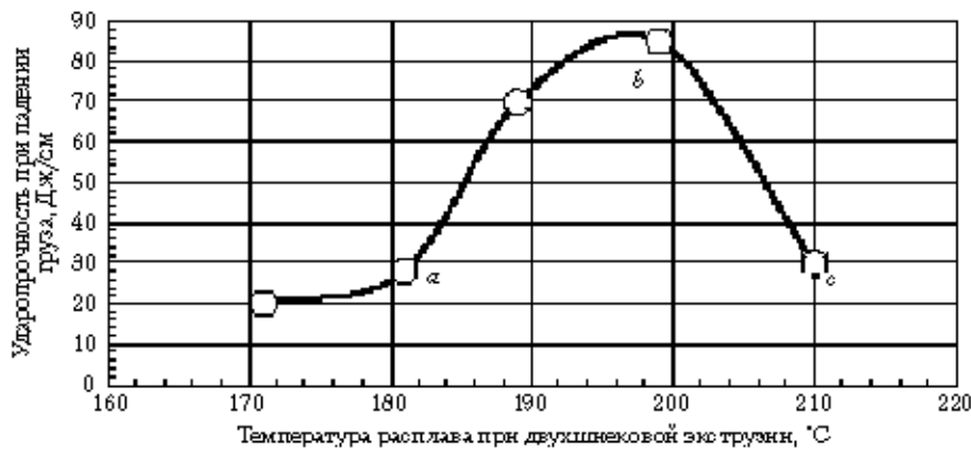
Рис. 6.16. Ударпрочность листа, содержащего 1 phg стеарата кальция и 1 phg парафинового воска
