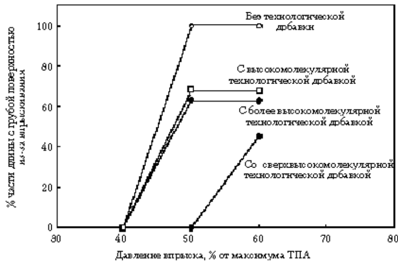
Рис. 6.8. Влияние технологических добавок (1 phr) на снижение вероятности струйного течения при литье под давлением смеси ПВХ К = 60
