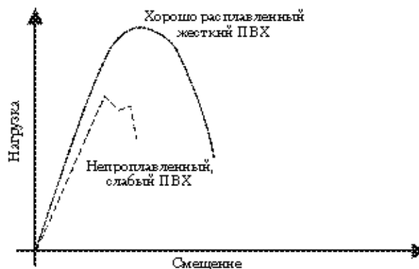
Рис. 16.5. Влияние степени плавления на ударные свойства ПВХ: хорошо расплавленные смеси демонстрируют лучшие ударные свойства по сравнению с непроплавленными
