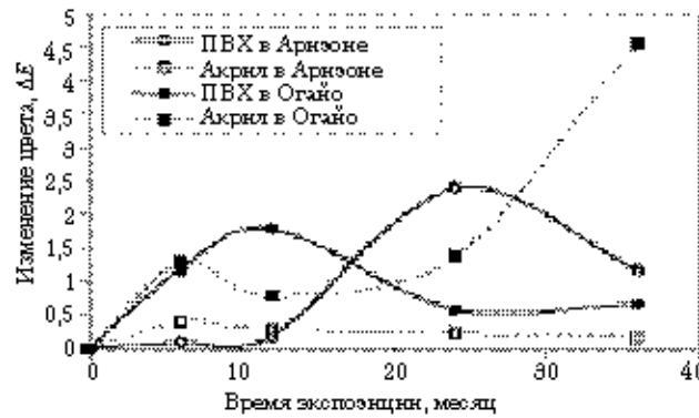
Рис. 14.4. Смещение цвета серого винила и серого акрила в климатах Аризоны и Огайо
