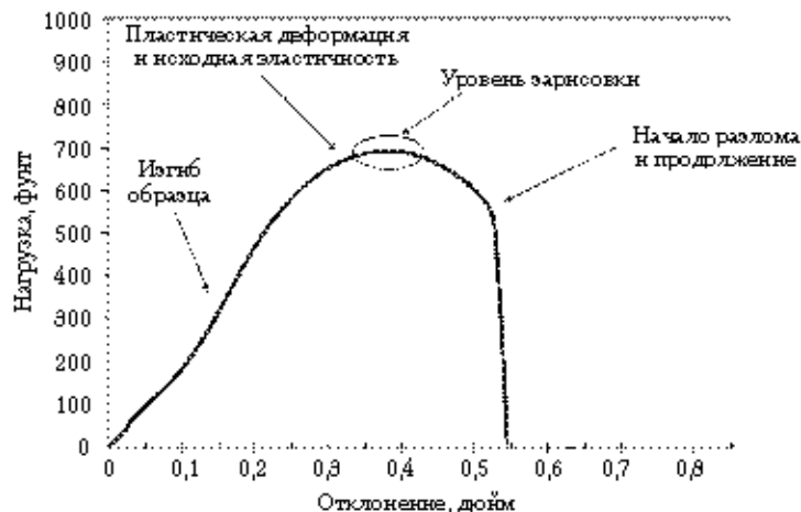
Рис. 12.14. Инструментально измеренная кривая воздействия для жесткой ПВХ-смеси
