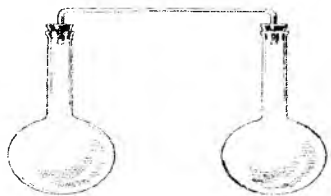
Rasm 69. Temperatura o'zgarishi bilan kimyoviy muvozanatni siljishini o'rganish uchun asbob.
