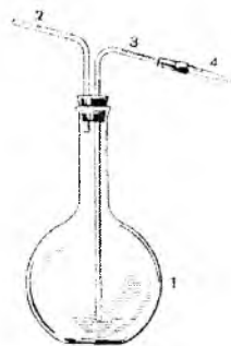
Rasm. 51. Yuvgich: 1-tagi yassi kolba; 2-o'tmas burchak ostida egilgan trubka; 3-o'tkir burchak ostida egilgan trubka; 4-uchi cho'zilgan trubka.
