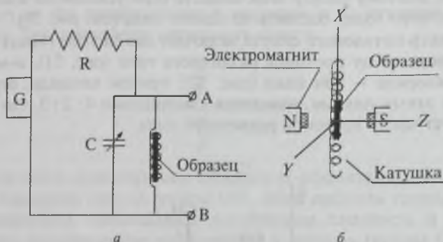
Рис. 29. Схема высокочастотного контура прибора ЯМР: G — генератор; R — сопротивление; C — конденсатор; A, B — клеммы
