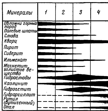
Рис. 23. Изменение минералогического состава при образовании коры выветривания пород среднего карбона (Самодуров, 1952)
