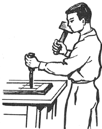
45-rasm. Yog'ochni o'yishda ishlovchining turish holati.
