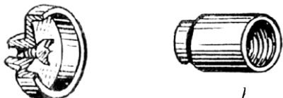
53-rasm. Zagotovkani mustahkamlash moslamalari: a-trezubes; b-patron.
