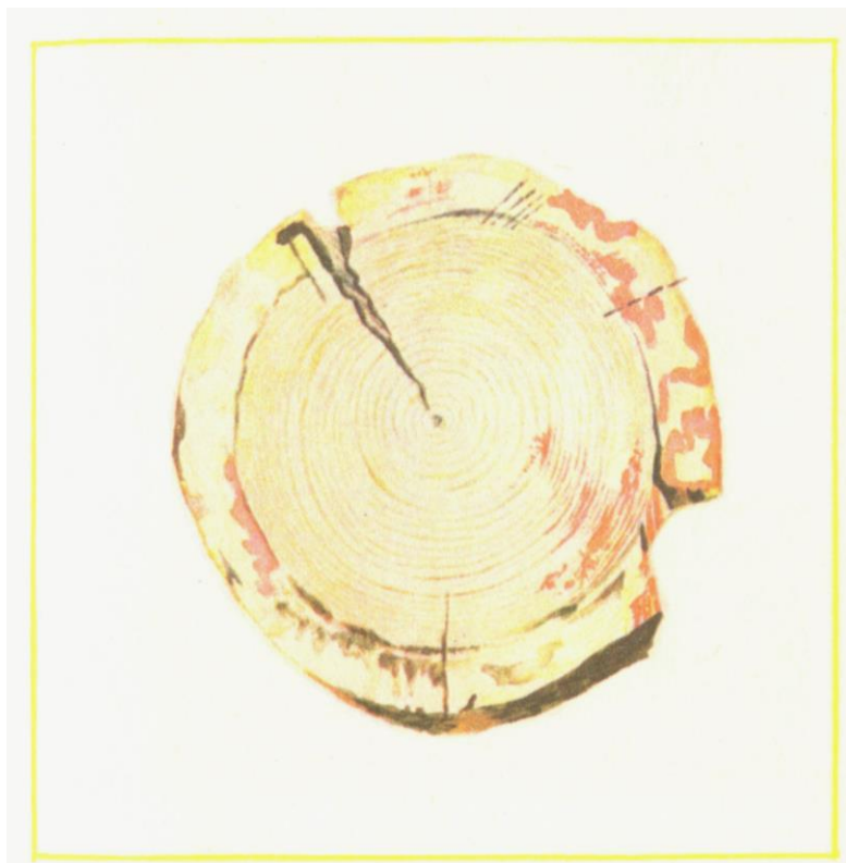
6-расм. Ёғочнинг ёрилиши.
