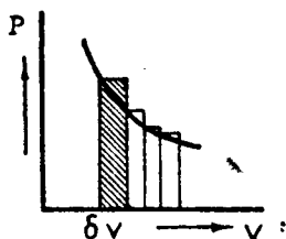
3-расм. Газларнинг изотермик кенгайиши.
