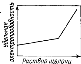
Рис. 11.7. Вид кривой при кондуктометрическом титровании слабой кислоты сильным основанием.
