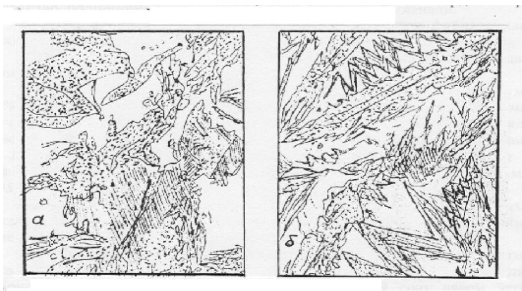
21- шакл. Пластинка (а) ва таёқча (б) шаклидаги мартенситнинг микротузилиши
