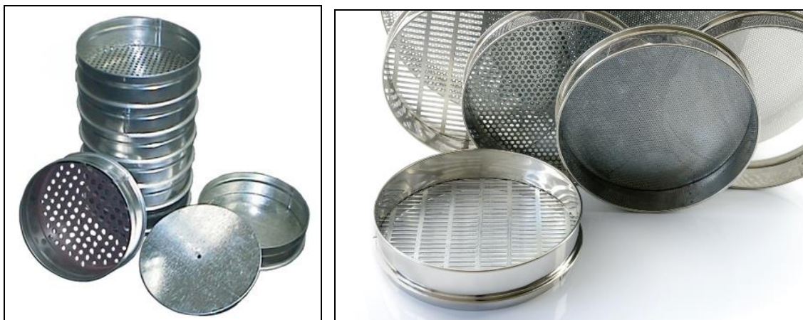
39-rasm. SLP-200 elak (katakchalari 1,0x20 o'lchamli) granulometrik tarkibni qo'lda ham, analizatorlar tarkibida ham elakdan o'tkazuvchi quyma elaklar.
