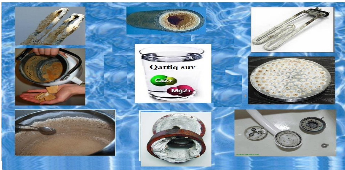
14-rasm. Uskunalariga qattiq suvning salbiy ta'siri
