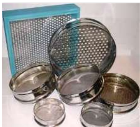
6-rasm. Har xil o'lchamdagi elaklar to'plami
