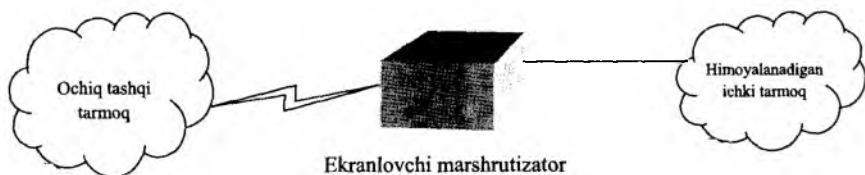
8.10-rasm. Tarmoqlararo ekran – ekranlovchi marshrutizator.
