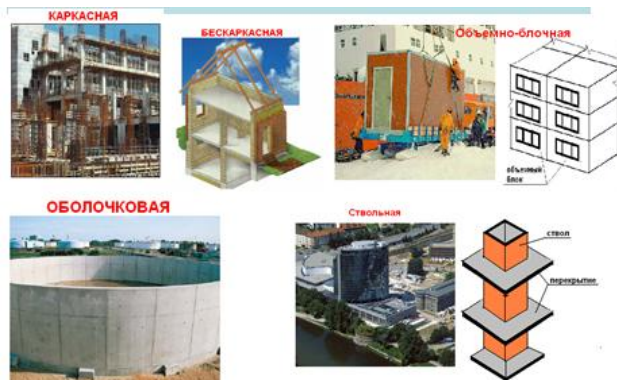
1-rasm. Konstruktiv tizimlarning asosiy ko`rinishlari
