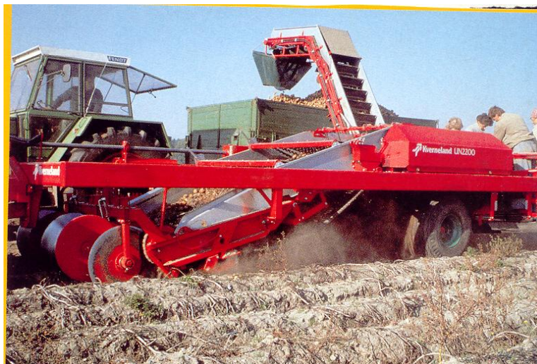
82 расм. Гримме ва Квернеланд компанияларининг картошка ҳосилини йиғиштирадиган икки қаторли комбайни.
