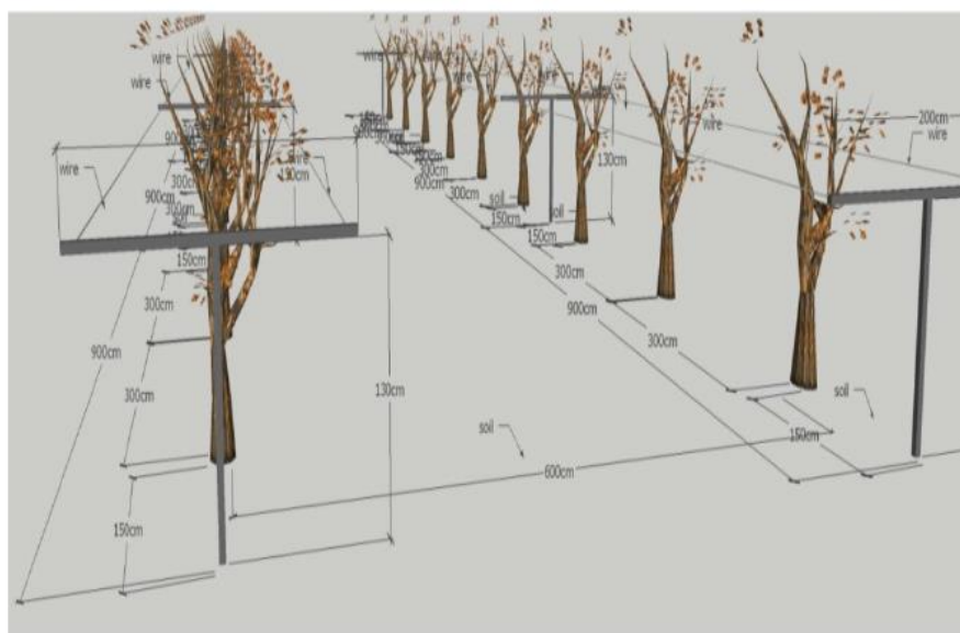
5-rasm. Anor oʻsimligiga simbagʻaz oʻrnatish usullari. T shaklidagi simbagʻaz.
