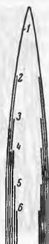
3.3-rasm. Lub poyalorida birlamchi va ikkilamchi tolalarning joylashishi: 1—birlamchi tolalar; 2,3,4,5,6—ikkilamchi tolalar.
