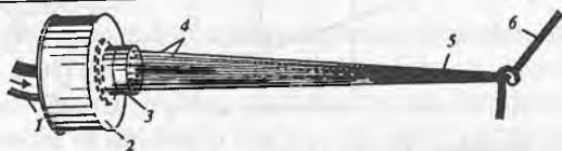
6.9-rasm. Tolaning hosil qilish sxemasi: 1—polimer eritmasining filera kallagiga kelishi; 2—filera kallagi; 3—filera; 4—tola shaklidagi eritma oqimi; 5—hosil bo'lgan tolalar dastasi; 6—ip.
