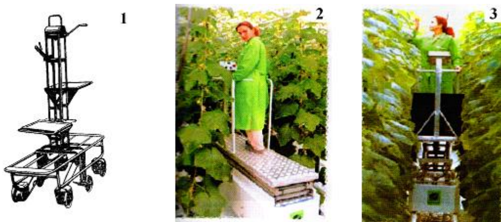
41-расм. Ўсимликларга шакл бериш ва ҳосилни йиғишда фойдаланиладиган силжиб юрадиган платформа:
