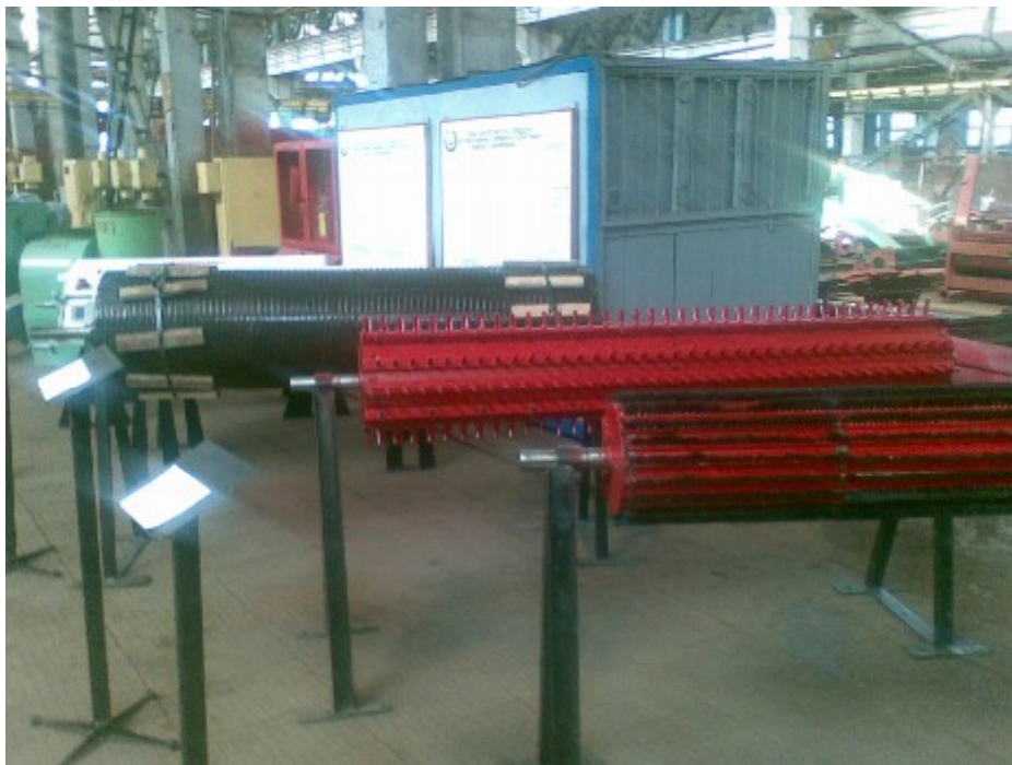
11- расм УХК пахта тозалаш агрегатини ишчи қисмлари
