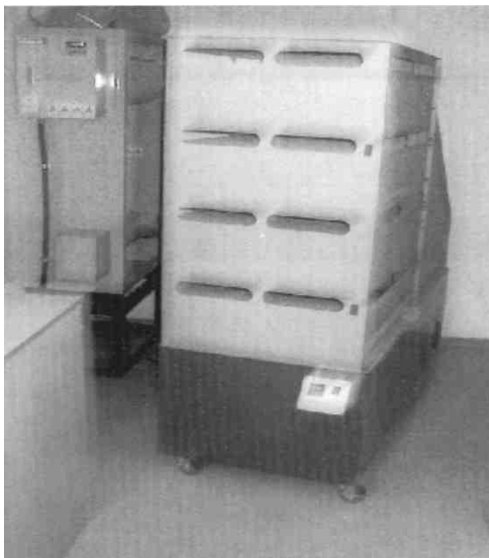
III.12-rasm. Paxta tolasini konditsiyalash javoni.
