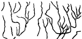
3.5.2-rasm. Shudgor qilingan yerda ariqchalar hosil qilib tuproqning yuvilishi:
