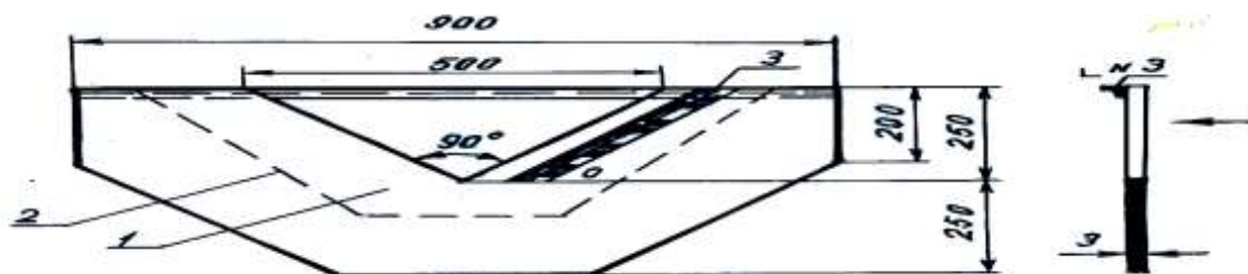
1-асбобнинг қуйи қисми, 2-суғориш тармоғининг кесими, 3-сув ўлчаш рейкаси.
