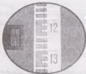
10-rasm. Trubaning ko'rish maydoni va reykanan sanoq 1257
