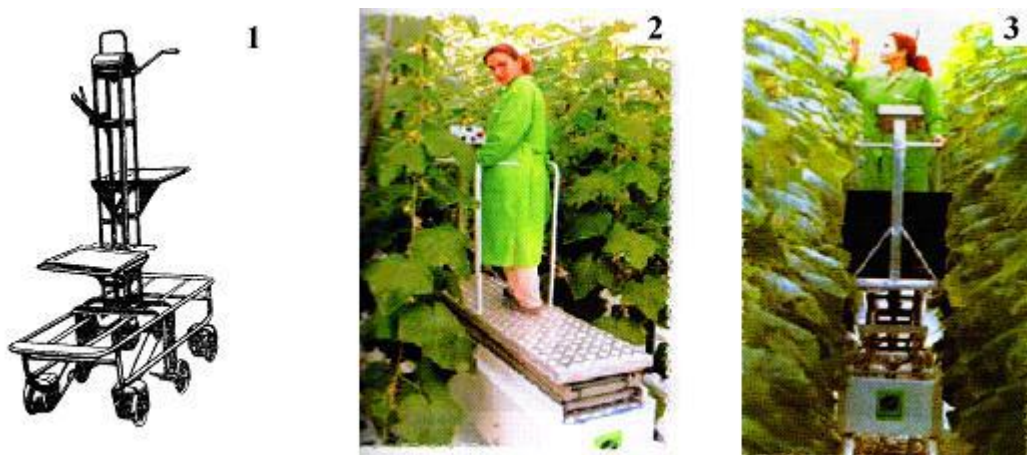
41-расм. Ўсимликларга шакл бериш ва ҳосилни йиғишда фойдаланиладиган силжиб юрадиган платформали нарвон:
