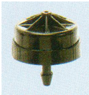
Босимни компенсациялайдиган (тиклайдиган) томчилатиш мосламаси. Сув сарфи: 2, 4, 8,5 л/с
