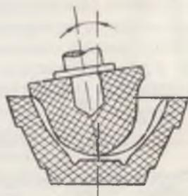
Рис. 37. Схема изготовления пиалы с помощью ролика
