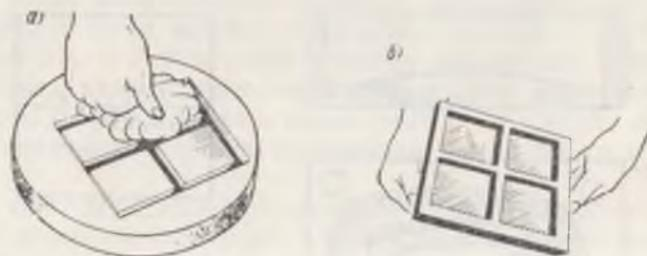
Рис. 43. Ручное прессование плитки типа изразца с упрочняющими перемычками
