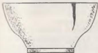
Рис. 45. Трещина, образовавшаяся при сушке, расширяется снизу вверх
