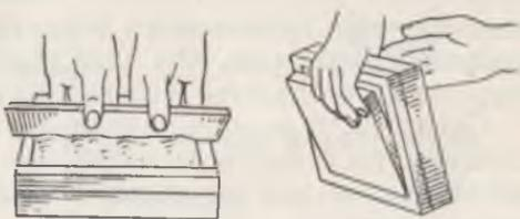
Рис. 12. Формование плитки в деревянной форме
