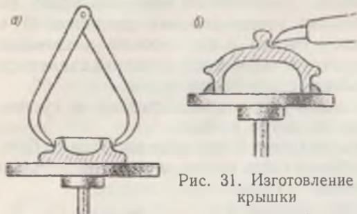
Рис. 31. Изготовление крышки
