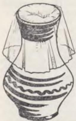
Рис. 44. Замедление сушки при помощи полиэтилена или фольги
