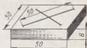
Рис. 57. Размеры и разметка плитки для определения усадки
