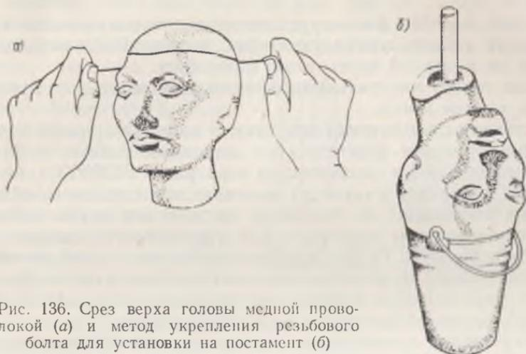
Рис. 136. Срез верха головы медной проволокой (а) и метод укрепления резьбового болта для установки на постамент (б)
