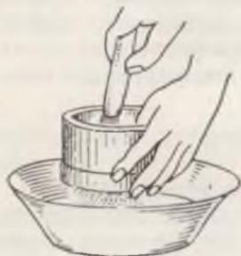
Рис. 63. Пропускание глазурной суспензии через сито
