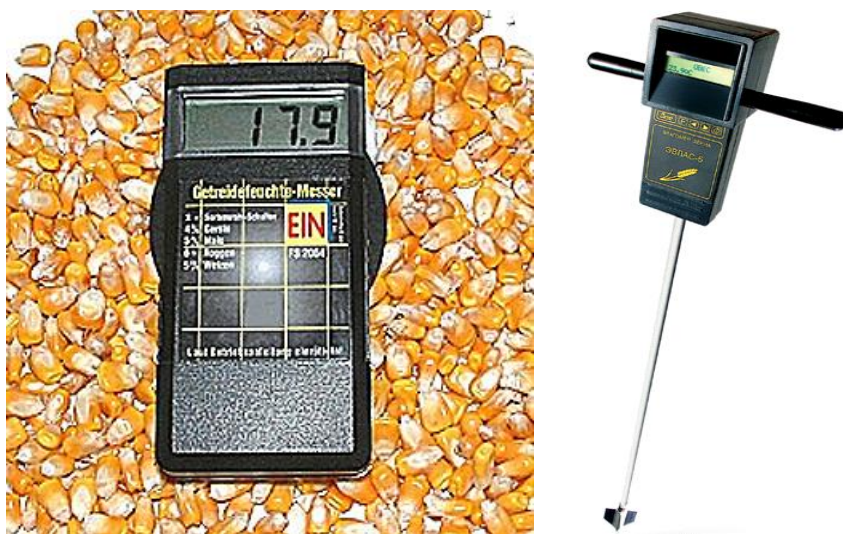
1-rasm. Don namligini aniqlaydigan zamonaviy elektron asboblarda
