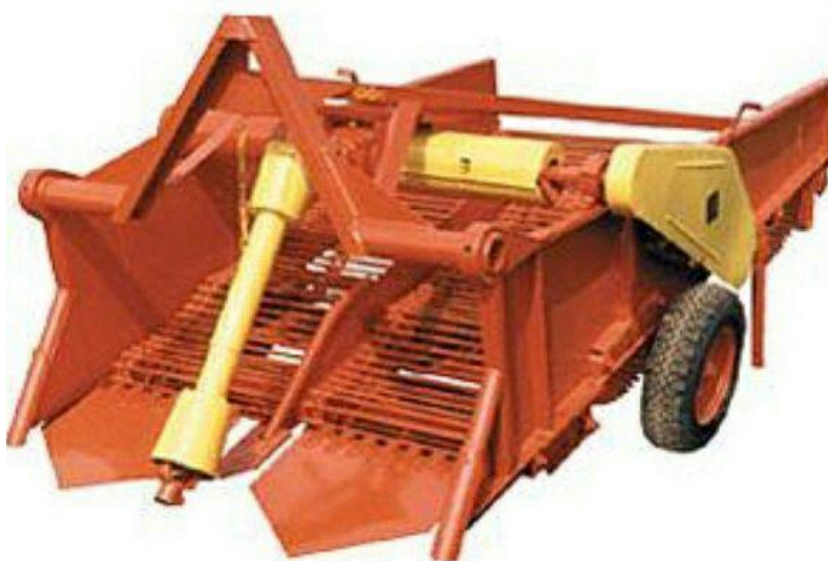
2.67-rasm. KN-2 rusumli kartoshka kovlash mashinasi kartoshka tuganaklarini tuproq bilan birgalikda kovlab olish uchun mo'ljallangan
