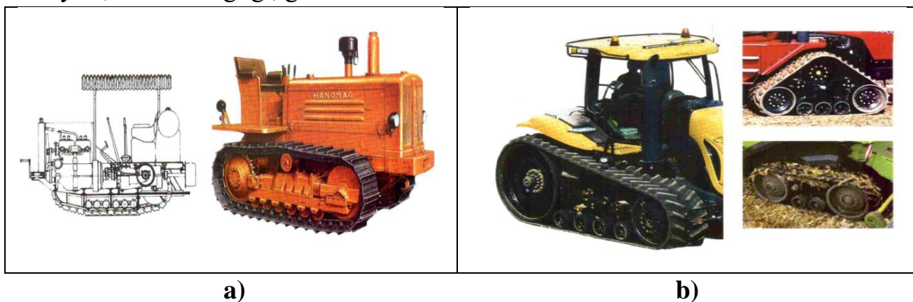
1.4-rasm. Zanjirli traktorlar: a-temir va b-rezinali
