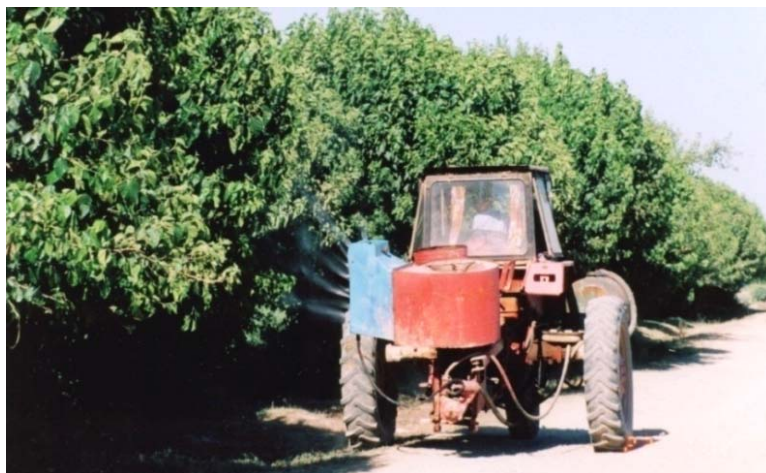
101-расм. Тутларга ишлов бериш ҳамда баландлик бўйича қамраш кенглигини оширишга мўлжалланган махсус мослама билан жиҳозланган ОВХ-28 пуркагичи.
