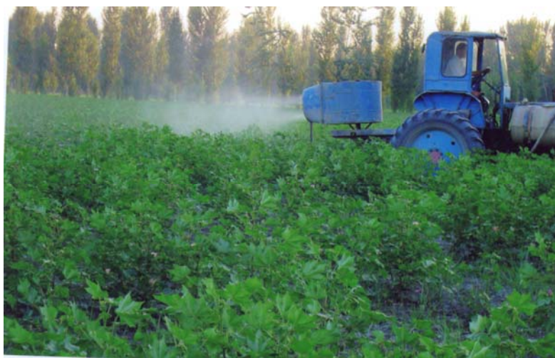
125-расм. Пестицидларни синашда ОВХ-28 русумли трактор пуркагичдан кенг фойдаланади. Ҳаво оқимиға таянган бу пуркагич ўргимчакканани ҳамда ҳашаротларни тарқатиб юбориши мумкин.
