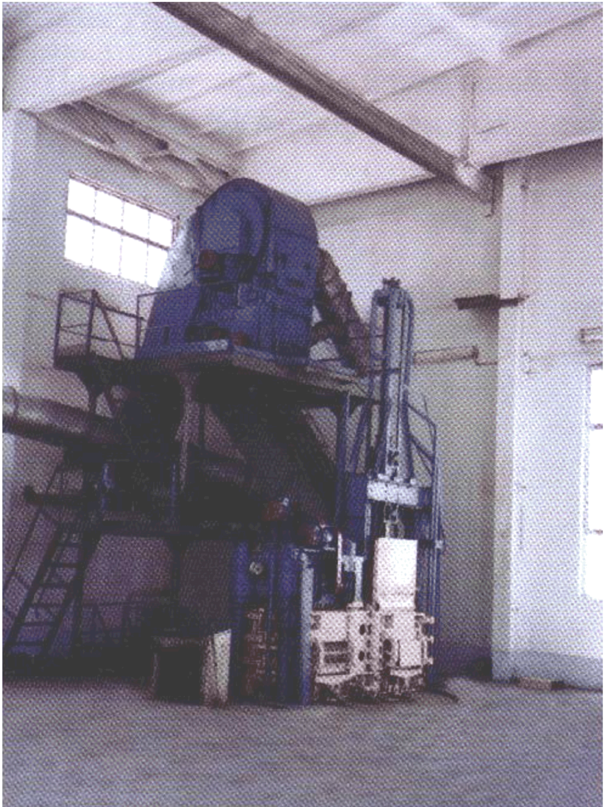
38-rasm. Paxta tolasini toylashda ishlatiladigan AK ДБ-8238.31 rusumli gidravlik press (zichlash) qurilmasi.
