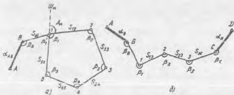
9.1-расм. Теодолит йўллари схемалари: a —ёпиқ; b —очиқ
