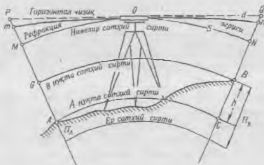
7.3-расм. Ер эгрилиги ва вертикал рефракциянинг нивелирлашга таъсири.
