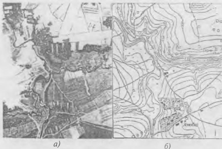
1.11-расм. Жойнинг аэрофотографик тасвири (а) ва у бўйича тузилган топографик план (б).
