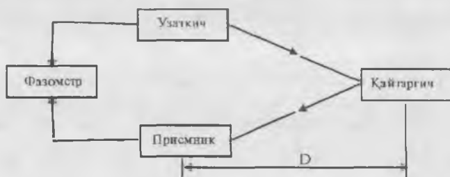
6.9-рasm. Дальнометриянинг фазали методини реаллаштириш схемаси
