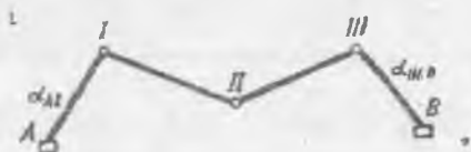
10.3- расм. Тахеометрик йўл схемаси
