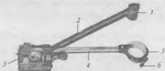
9.14-расм. ПП-М кутбли планиметр: 1—кутб, 2—кутбли ричаг, 3— санок олиш механизми 4—айланиш ричаги, 5—айлантириш индекси, 6—даста
