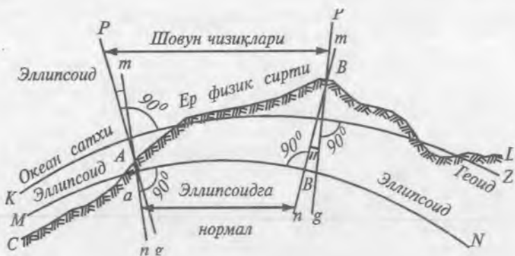
1.2-расм. Геоид ва эллипсоид кўриниши: pq — шовун чизиқ, mn — эллипсоидга нормал (перпендикуляр) чизиқ, u — шовун чизиқ огиши.
