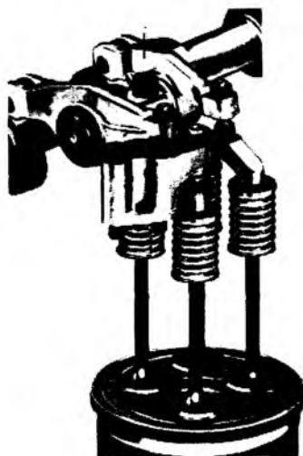
4.9-rasm. Silindrning yuqorisida uchta klapaning joylashuvi.
