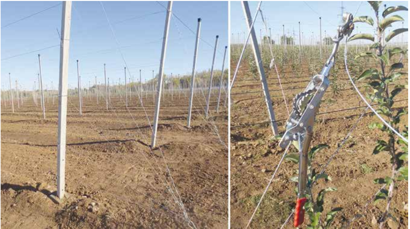
Расм-219. Симларни таранг тортиш учун қўлланиладиган тортувчи мослама.
