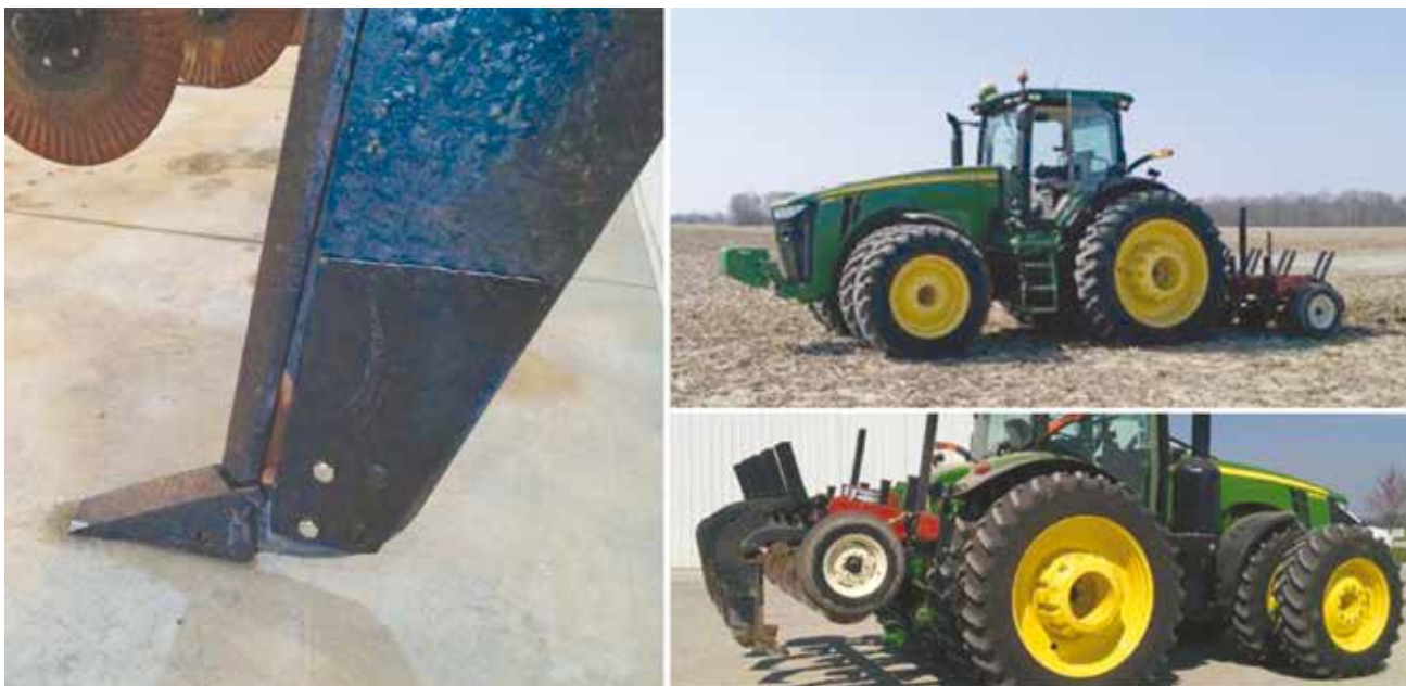
Расм-45. Берч қатламни юмшатишда қўлланиладиган трактор ва мосламалар.
