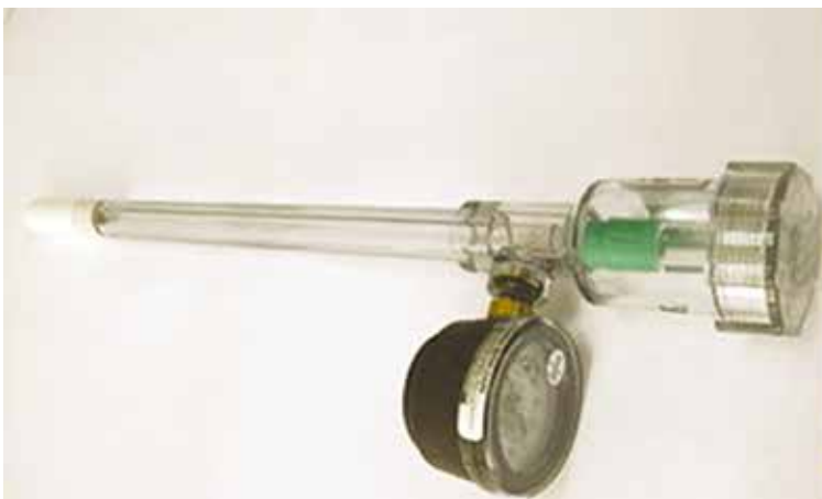
Расм-53. Тензиометр – тупроқ намлигини ўлчовчи асбоб.
