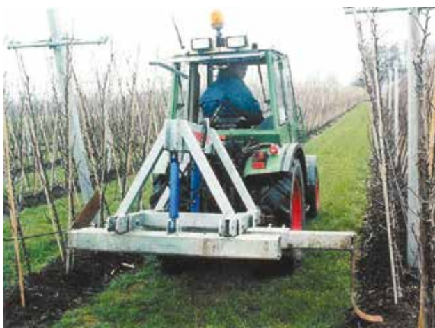
Расм-216. Илдиз қирқишда фойдаланиладиган мослама.
