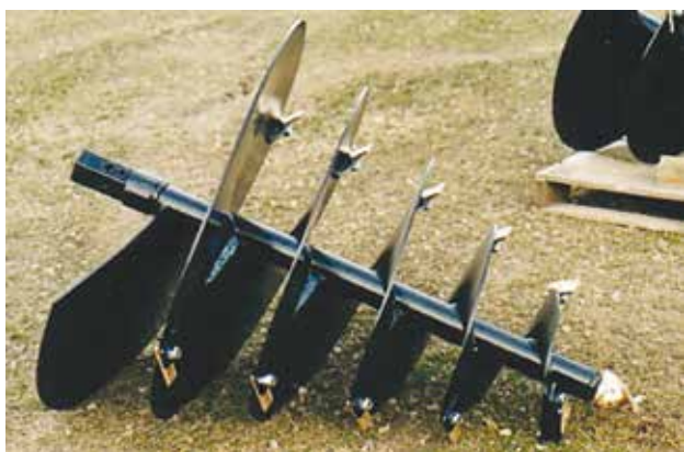
Расм-48. Катта чуқур қазувчи мосламадан фойдаланиш ил-дизларни яхши ривожланишида муҳим аҳамият касб этади.
