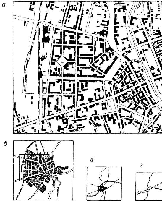
Рис. 7.4. Генерализация населенного пункта. Последовательная замена отдельных объектов (здания — а ) собирательными знаками (кварталы, общий контур города — б, в ) и абстрактным значком (пунсон — г ).
