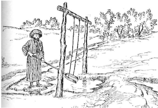
1-Rasm. Suvni qo'l kuchi yordamida yoqoriga ko'taruvchi inshootlar (sepma)
