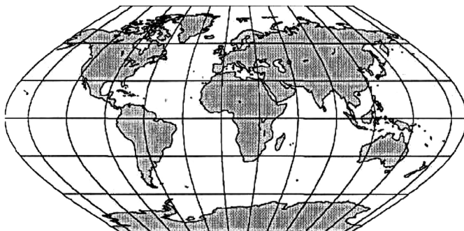
45-rasm. Ekkert V- erkin sinusoidli psevdosilindrik proyeksiya. Parallel va meridianlar teng oraliqlarda o'tkazilgan. O'rta va meridian qutblar chizig'i ekvator uzunligining yarmiga teng. \pm 37^{\circ} 55' kenglikdagi parallellarda masshtab saqlanadi.
