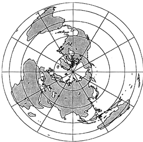
20-rasm. Normal azimutli teng katta proyeksiya. ( Qutbdan uzoqlashgan sari parallelar oraliq farqlari yo'qolib boradi. )
