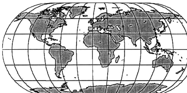
43-rasm. Ekkert III- erkin elliptik psevdosilindrik proyeksiya. Parallel va meridianlar teng oraliqlarda o‘tkazilgan. Chetki meridianlar – aylana yoylari. O‘rta meridian va qutblar chizig‘i ekvator uzunligining yarmiga teng. \pm 35^{\circ} 58' kenglikdagi parallellarda masshtab saqlanadi.
