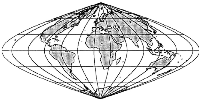
47-rasm. Erkin psevdosilindrik giperbolali proyeksiya, ularning meridiani, oʻrta meridian toʻgʻri chiziq, tashqari,- ekvator uzunligining yarmiga teng. Parallel va meridianlar teng oraliqlarda oʻtkazilgan. \pm 21^{\circ} 14' kenglikdagi parallellarda masshtab saqlanadi. Proyeksiyani 1934-yili R.V.Putninch (Latviya) taklif qilingan.
