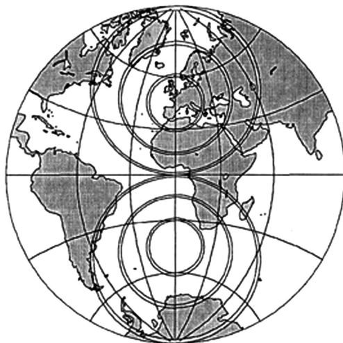
12-rasm. Ko‘ndalang azimutli stereografik proyeksiyasidagi halqalar ekvatorga yo‘nalishda aralash tasvirlangan.
