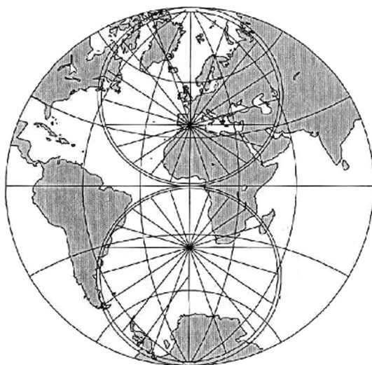
13-rasm. Ko‘ndalang azimutli stereografik proyeksiyasida shardagi doira aylana bilan tasvirlangan.
