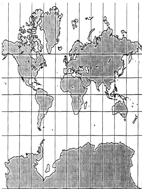
38 - rasm. Merkatorning normal teng burchakli silindrik proyeksiyasi.
