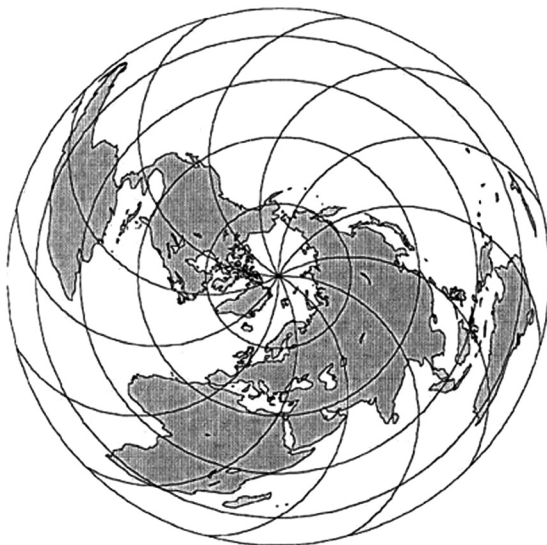
23-rasm. Vixelning normal psevdoozimuthli teng kattalikli proyeksiyasi.
