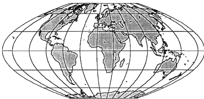
48-rasm. Teng kattalikli psevdosilindrik parabolali Mak Brade – Tomasning proyeksiyasi. Oʻrta meridian (koʻrsatilmagan)-toʻgʻri chiziq, u ekvator uzunligining 0,48 qismiga teng. Meridianlar teng oraliqlarda oʻtkazilgan. Qutbiy chiziqlar uzunligi ekvator uzunligining uchdan bir qismini tashkil etadi. \pm 45^{\circ} 30' kenglikdagi parallellarda masshtab saqlanadi. Proyeksiyani 1949-yil F.V. MakBrade va P.D.Tomaslar (AQSh) taklif qilishgan.
