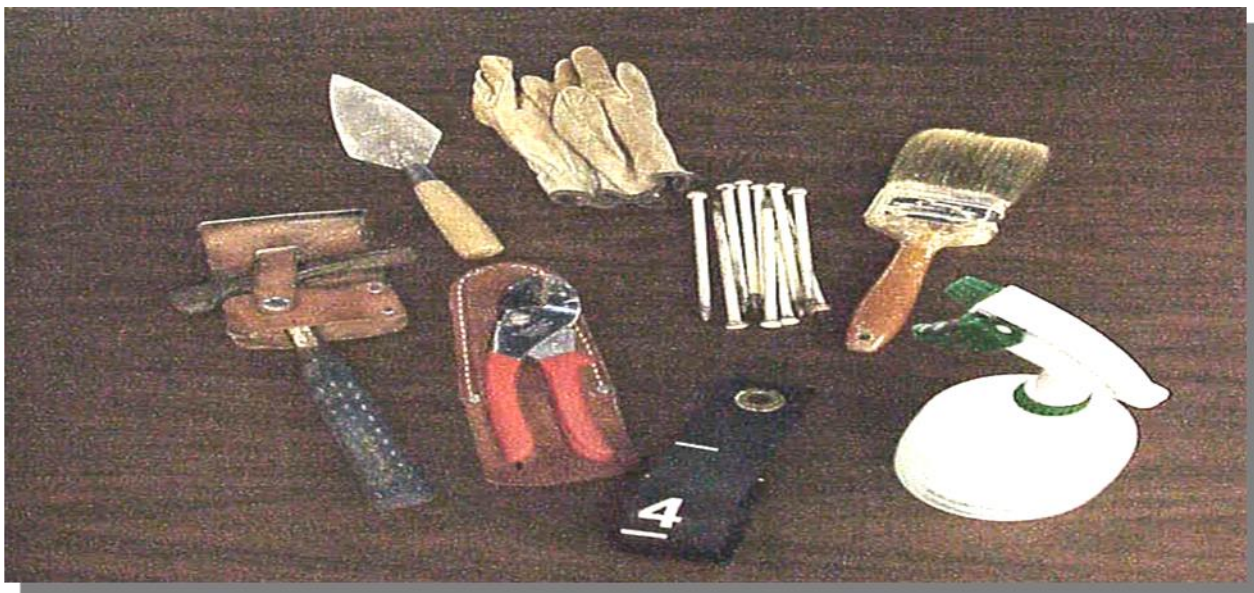
23-расм. Тупроқ кесмаларини ковлашда ишлатиладиган асбоб-ускуналар
