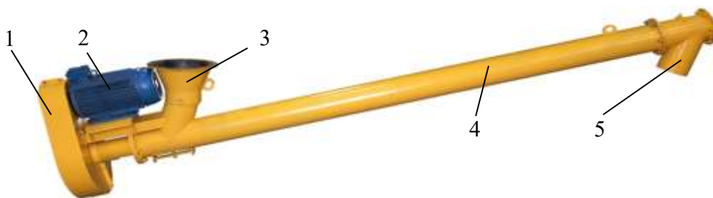
Рис. 3.132. Шнековый транспортер (общий вид): 1 – ременная передача привода; 2 – электродвигатель; 3 – загрузочный патрубок; 4 – желоб; 5 – выгрузной патрубок
