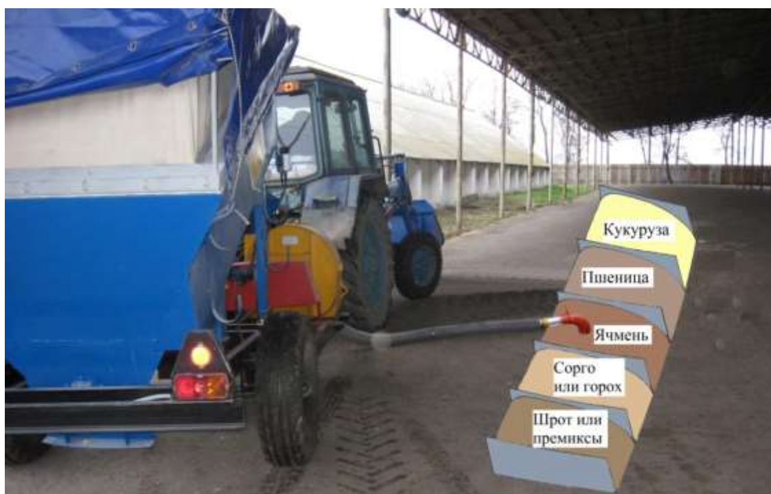
Рис. 4.16. Загрузка агрегатом АКМ-3М компонентов комбикорма
