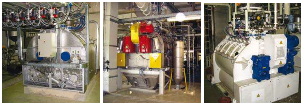
Рис. 3.95. Установка для вакуумного напыления «Pegasus Vacuum Coater»
