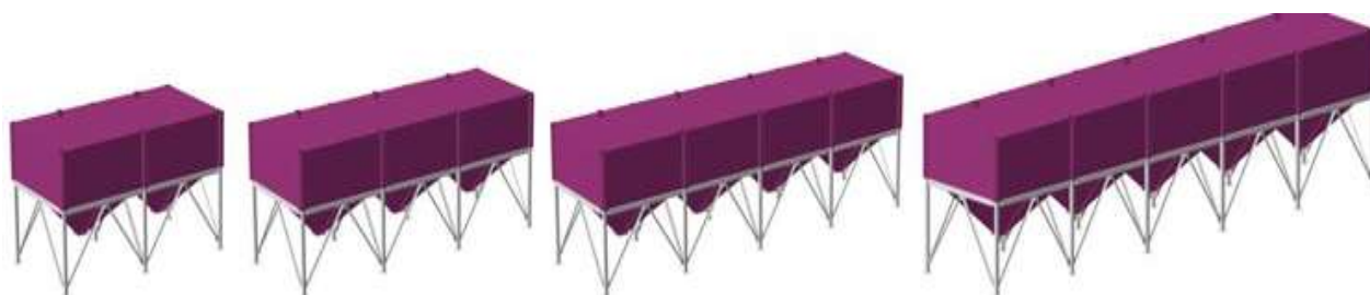
Рис. 3.120. Соединение бункеров для исходного сырья
