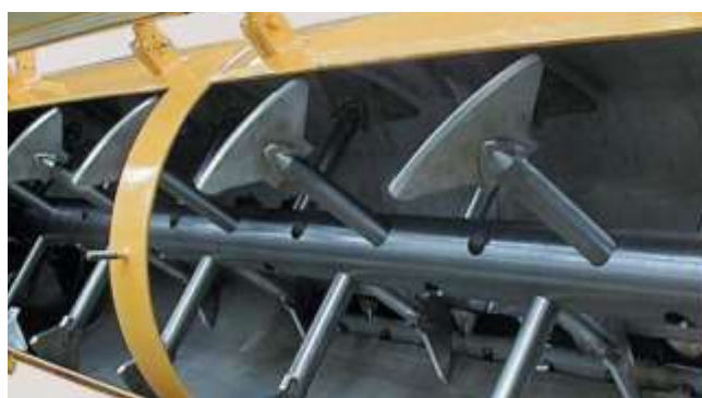
Рис. 3.56. Регулируемые лопасти смесителя-кондиционера МК «Amandus Kahl»
