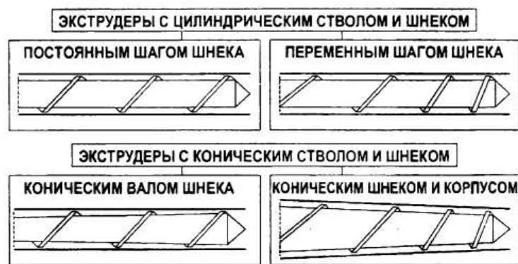
Рис. 3.65. Классификация одношнековых экструдеров по расположению и геометрическим параметрам шнека и корпуса (по В.А. Бурцеву [6])
