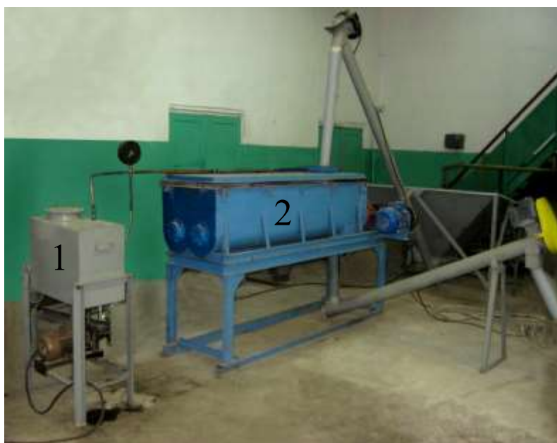
Рис. 3.90. Установка для приготовления и ввода жидких компонентов в состав комбикорма в комплекте со смесителем СК-15Н («АНЦ «Донской»): 1 – установка ввода жидкого сырья; 2 – горизонтальный смеситель
