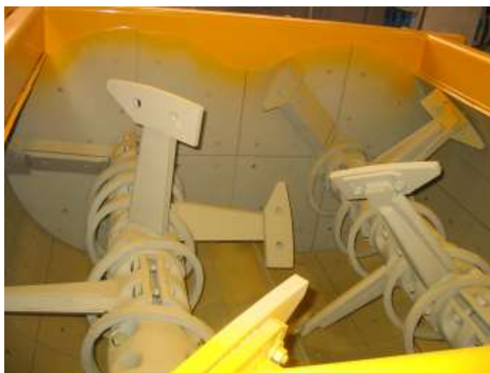
Рис. 3.29. Двухвальный горизонтальный смеситель
