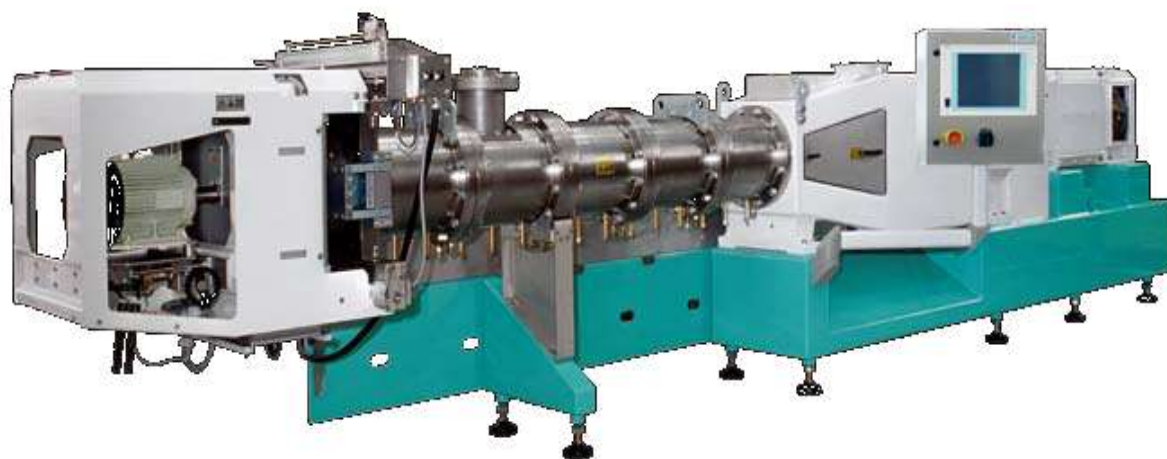
Рис. 3.74. Двухшнековый экструдер POLYtwin «Buhler»
