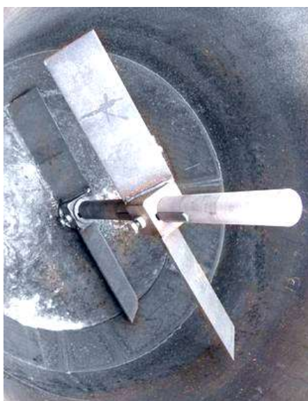
Рис. 3.107. Лопастной вал вертикального смесителя премиксов СМ
