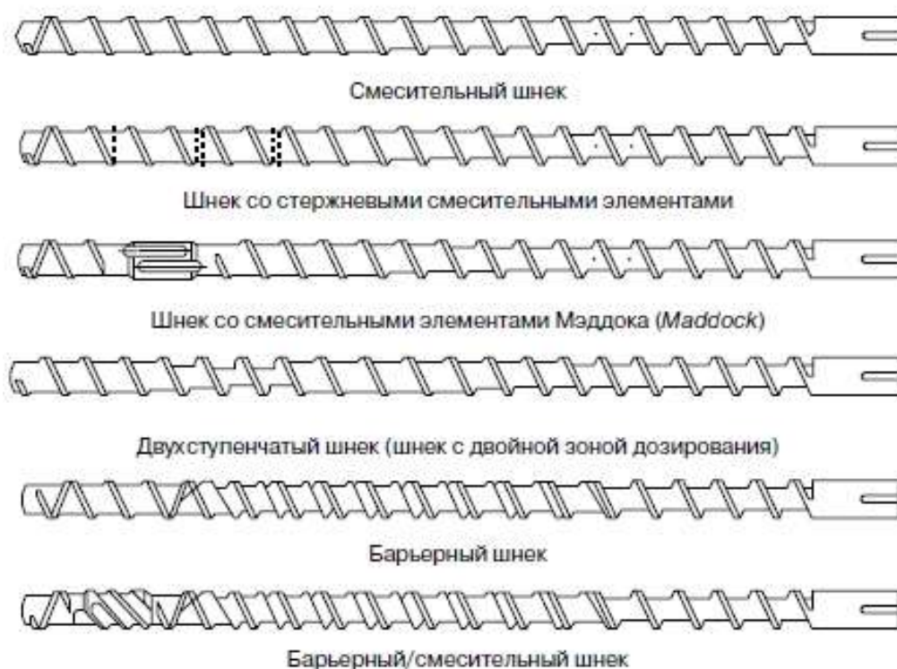
Рис. 3.61. Виды шнеков экструдера (по Д.Р. Вагнеру)
