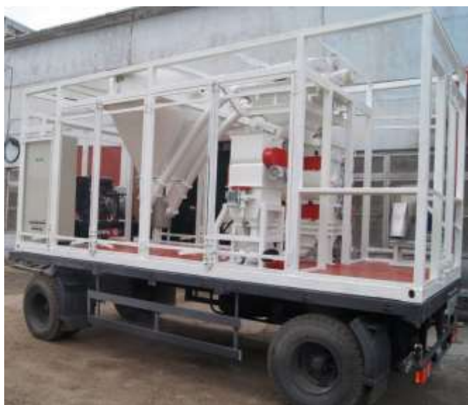
Рис. 4.19. Мобильная установка для приготовления лекарственных кормосмесей «ВНИИКП»: а – общий вид; б – схема устройства;
