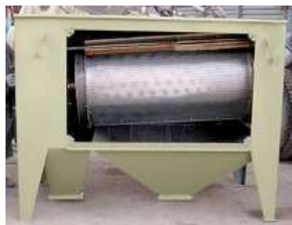
Рис. 3.1. Сепаратор зернофуража СФ-50 (СК-1): 1 – корпус; 2 – щетки; 3 – перфорированный цилиндр; 4 – загрузочный патрубок; 5 – выгрузное окно для очищенного зерна; 6 – выгрузное окно для отходов
