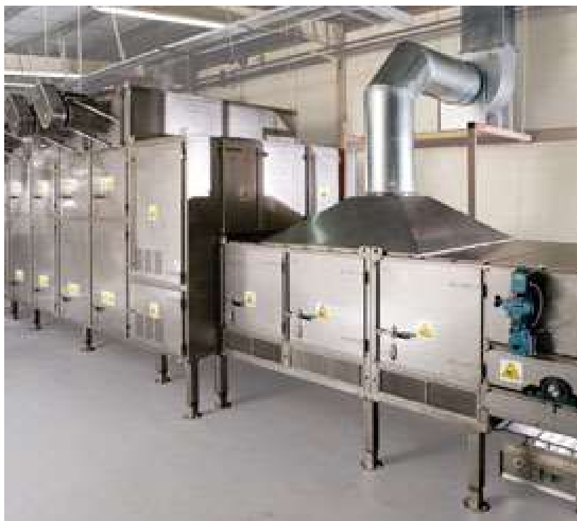
Рис. 3.87. Многоступенчатая ленточная сушилка AeroDry «Buhler»
