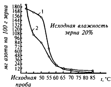
Рис. 60. Изменение активности протеолитических ферментов и резистентность белков зерна пшеницы при сушке в кипящем слое:
