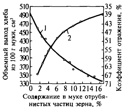
Рис. 66. Зависимость объемного выхода (1) и белизны мякиша (2) хлеба от содержания в муке отрубянистых частиц зерна
