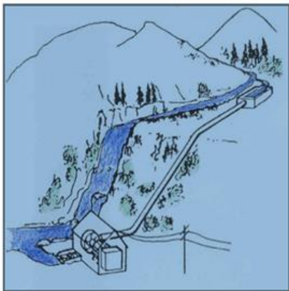
a – derivatsion (suvni asosiy o'zandan tarmoqlab olish)
