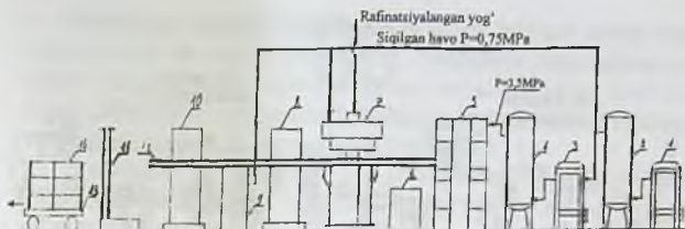
1.20-rasm. «Steka» firmasining yog'larni PET idishlarga qadoqlash liniyasi.
