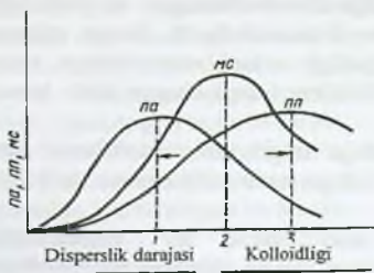
5.4-rasm. Sovun eritmasi (SE)ning yuvish qobiliyatini sirt aktivlik (SA) va sirt mustahkamligi (SM)ni eritmadagi yuvuvchi modda dispersligi (kolloidlik)ga bog'liqligi.
