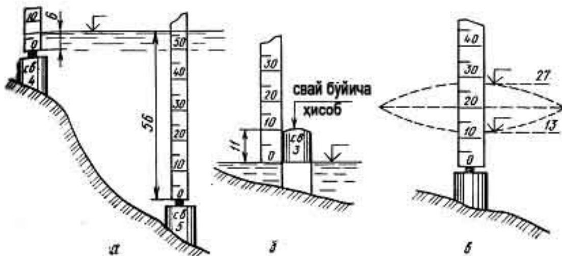
9.1 – расм Сув ўлчаш постларида сув сатҳини ўлчаш вариантлари: а – икки свай бўйича; б – кузатиш нулидан пастда жойлашган сув сатҳи бўлганда; в – эркин сатҳда тўлқинланиш бўлган шароитда. Ўлчанлари см. да.
