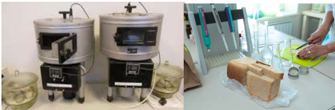
9-rasm. SESh shkafi va eksikator, nonning namligini aniqlash jarayoni.
