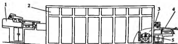
17-rasm. Sovutuvchi yopiq tipdagi AOK agregati.
