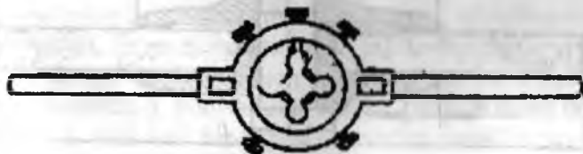
1.23-rasm. Tashqi rezba kesish uchun vorotok va plashka.
