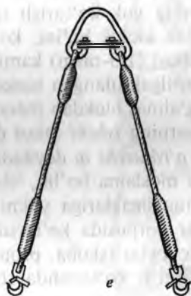
1.7-rasm. Kanatli yuk ko'taruvchi stroplar.
