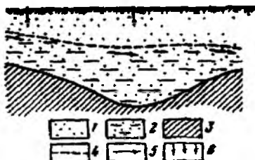
10.3-rasm. Sizot suvlari oqimi va savzasi. 1-qumlar; 2-suvli qum qatlami; 3-suv o‘tkazmas jins qatlami; 4-sizot suvining satsi; 5-sizot suvlari sarakatining yo‘nalishi; 6-atmosfera yo‘nlarining infiltratsiyasi
