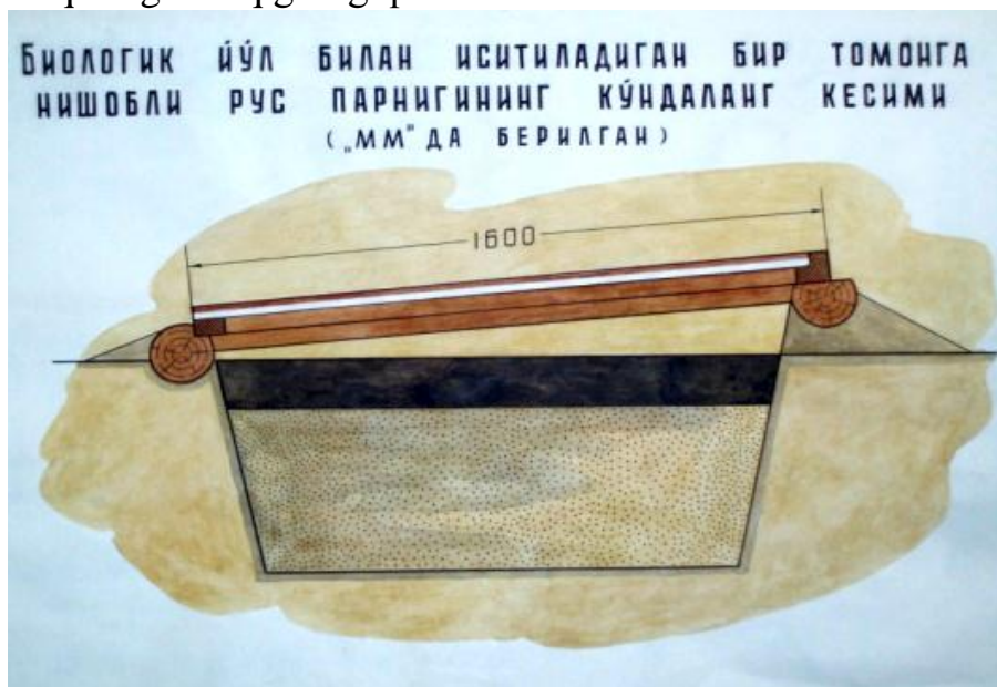
1-rasm. Bioyoqilg'i bilan isitiladigan Rus parnigi
