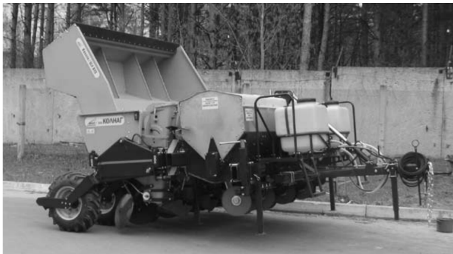
30-rasm. Lokal mineral o‘g‘it soladigan va urug‘lik kartoshkalarni himoyalash uchun dori sepuvchi moslamalar bilan jihozlangan Hassia SL 4 BZS kartoshka ekkich
