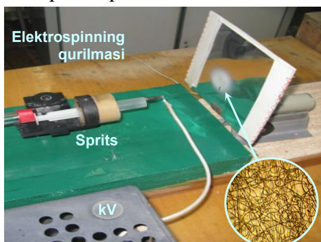
68-rasmda Laboratoriya tadqiqotlari uchun maxsus yig'ilgan elektrospinning qurilmasi fotosurati
