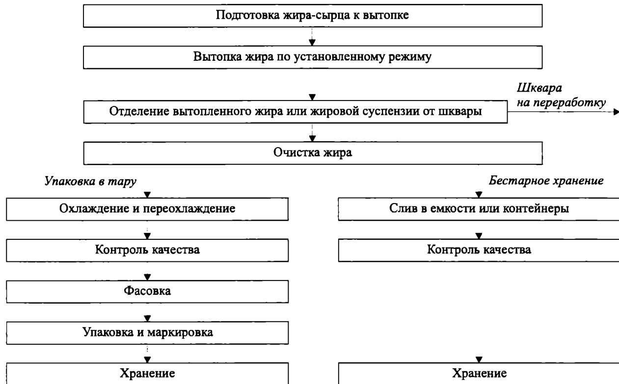
Рис. 3.1. Схема вытопки жира из мягкого жира-сырца
