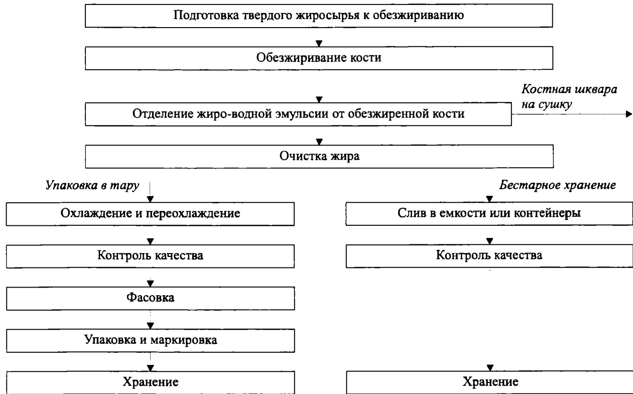
Рис. 3.2. Схема вытопки жира из твердого жирсырья
