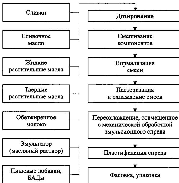
Рис. 7.1. Схема производства спредов и смесей топленых
