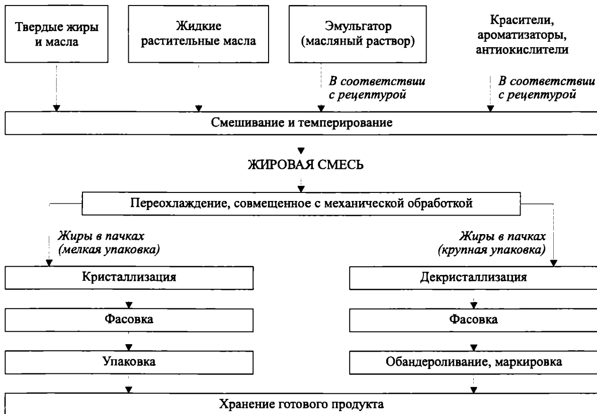
Рис. 5.3. Схема производства кулинарных, кондитерских и хлебопекарных жиров
