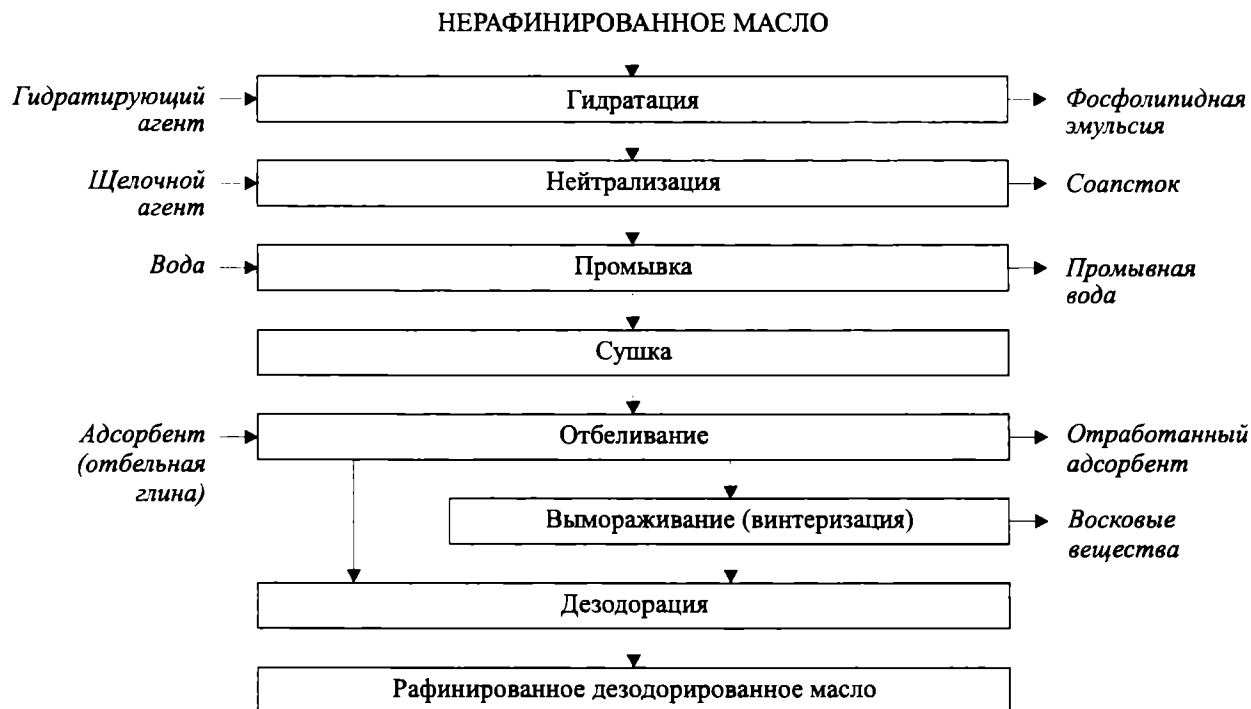
Рис. 2.3. Схема производства рафинированного дезодорированного масла
