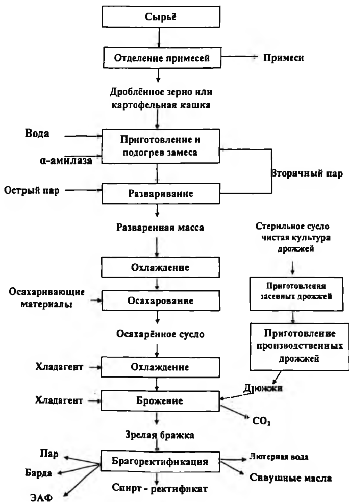
Рис. Принципиальная технологическая схема производства этилового спирта из зерна и картофеля.
