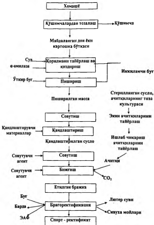
Дон ва картошкадан этил спирти ишлаб чиқаришнинг принципиал технологик схемаси.
